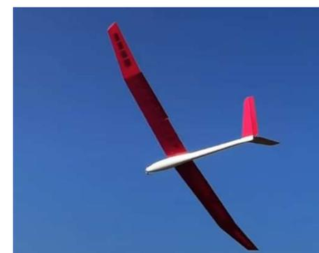
Das Abreißverhalten ist gutmütig. Die Fluggeschwindigkeit kann sehr weit zurückgenommen werden und ein schwammiges Flugverhalten kündigt den Strömungsabriss an. Bei flotterer Gangart sind die Querruder unerlässlich. Kleine Strecken können durch leichtes Drücken ohne Höhenverlust flott durchfliegen werden. Erhöht man die Geschwindigkeit weiter und lässt dann das Höhenruder los, setzt der Maxie, dank dem dicken Profil, die Geschwindigkeit wieder in Höhe um.
