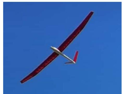
Dank dem sehr guten Gleitwinkel in Bodennähe sollten die Landeanflüge sehr flach erfolgen. Bei Fuß-Landungen gelingen bei geringer Geschwindigkeit ohne Probleme. Bei höherer Geschwindigkeit oder kräftigem Wind stelle ich die Querruder nach oben. Dabei muss aber der Querruder-Landeklappen-Mischer schon nahe am Maximum eingestellt sein, um hier eine einigermaßen gute Wirkung zu erzielen.
